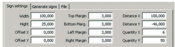
Sign Settings folgende Werte ein. Width = 100, Height = 30, Offset X and Y = 0, Alle Margins auf 3, Distance X = 100, Distance Y = -46, Quantity X = 6 (wenn der Arbeitsbereich des Lasers 600m beträgt), Quantity Y = 38 (dieser Wert sollte so groß, daß das Produkt aus X und Y größer als die Textanzahl ist).
